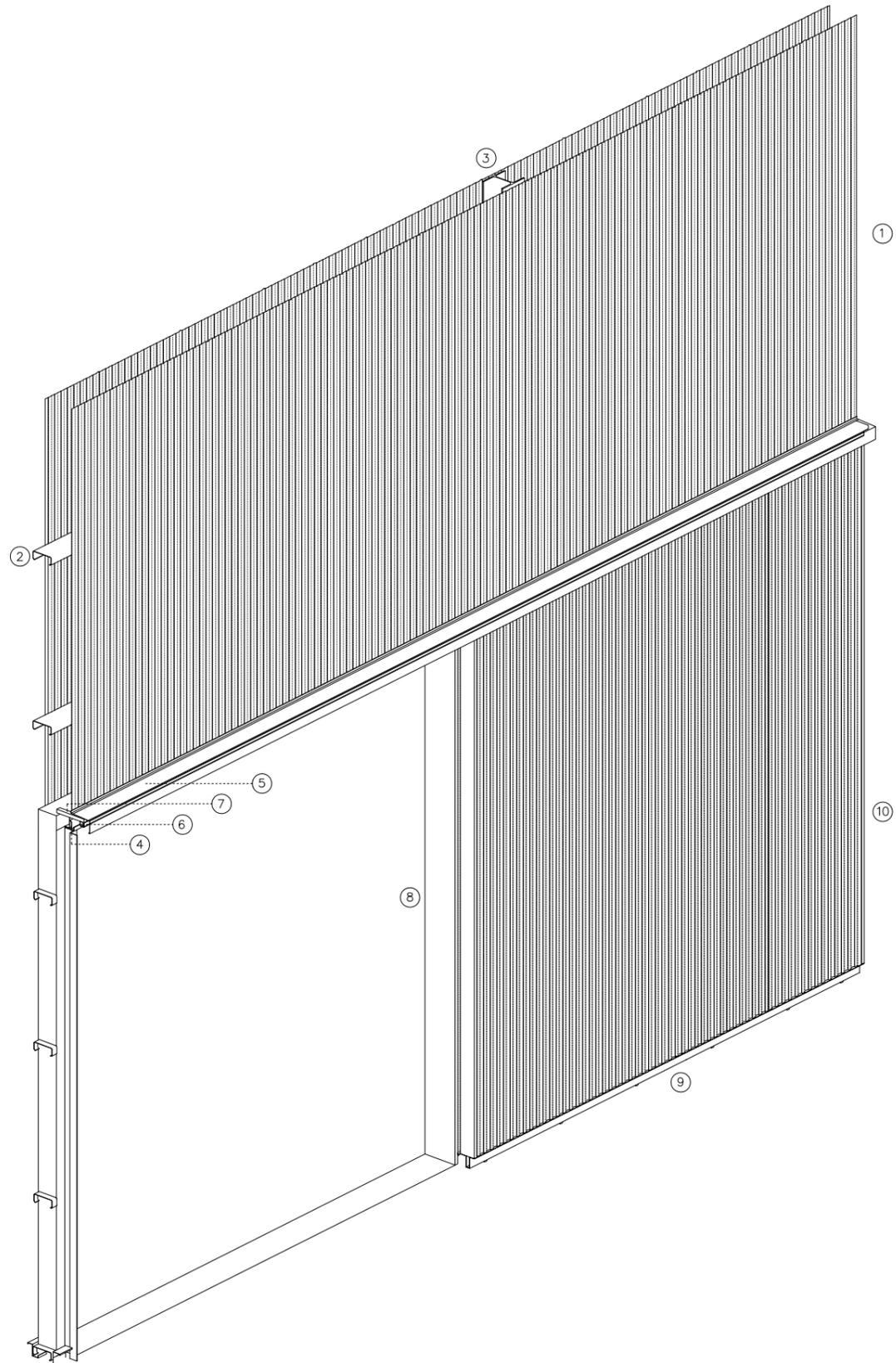
1\_CERRAMIENTO TIPO SÁNDWICH INSITU, CON ACABADO DE CHAPA MINIONDA GALVANIZADA, OMEGAS GALVANIZADAS PARA FIJACIÓN DE CHAPA Y TRIPE AISLAMIENTO TÉRMICO
