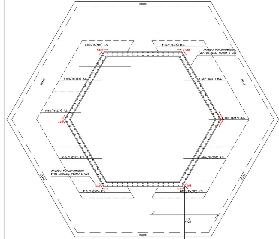
LOSA ARMADO SUPERIOR LONGITUDINAL
