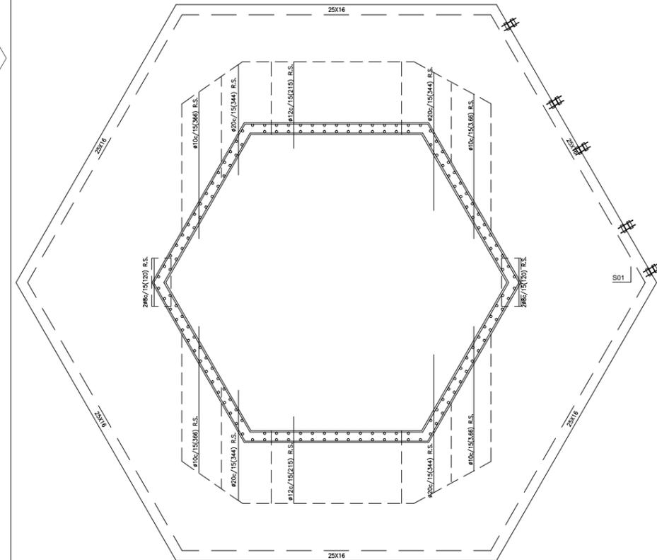
LOSA ARMADO SUPERIOR TRANSVERSAL
