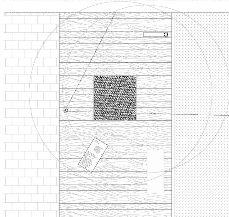
detalle de pavimentación y señalización de especies singulares E: 1/100
