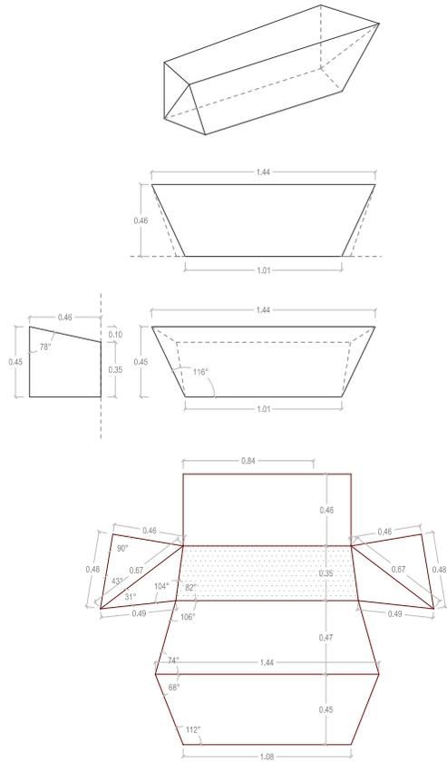
PLANTA, ALZADOS, AXONOMETRIA Y DESPLIEGUE DEL BANCO
