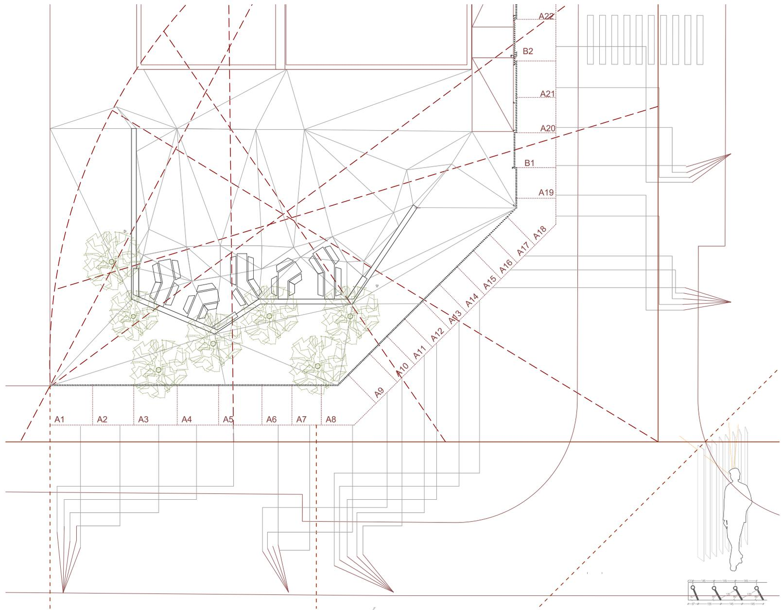
PLANTA CON MODULAJE DE LA VALLA SEGÚN ORIENTACIÓN DE LAS PLETINAS. E 1:250
